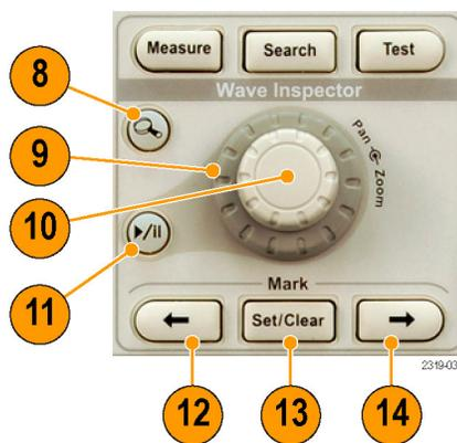
11. **播放/暂停按钮**。按此按钮可以开始或停止波形的自动平移。使用平移旋钮控制速度和方向。
