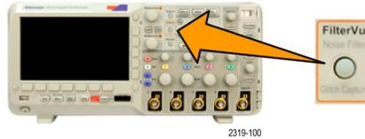
2. 旋转多功能旋钮 a 调节“噪声滤波器（前景）”值。
