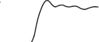
使用接地长导线的信号
