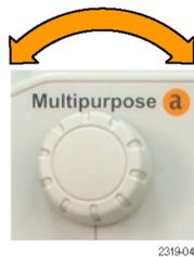
然后，旋转多功能旋钮 b 定义电压电平，高于该电平时，示波器将该信号视为高，低于该电平时，示波器将其视为低。
