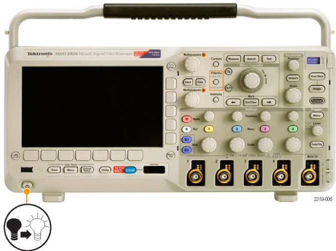
3. 将 TPP0200/TPP0100 探头端部和参考引线连接到示波器的 PROBE COMP “探头补偿” 连接器上。
