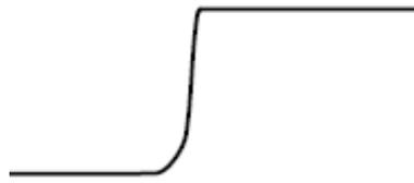
使用接地短导线的信号
