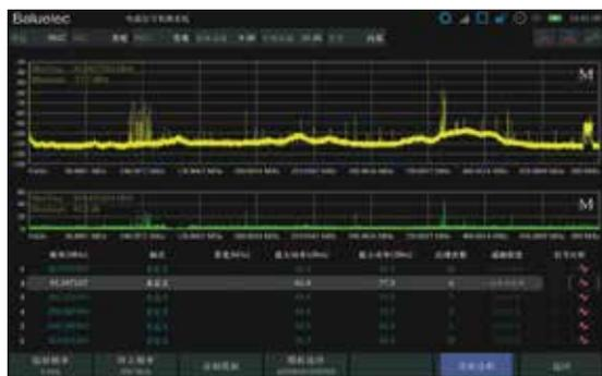
近场空间的窃听和窃视信号通过与背景电磁频谱差分获得初步信息,根据信号活动特征、功率大小、出现频次等多方面进行信号的威胁等级判定,最终筛选出威胁程度最高的六个信号。
