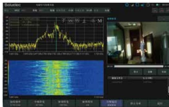
系统可以对常见的1.2G、2.4G和5.8G等针孔摄像头进行探测和解调,图像输出分辨率480\*320,制式包括NTSC、PAL和SECAM;支持四幅影像的录制和回放。
