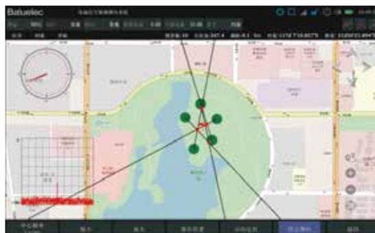
地图测向定位子系统主要由BD/GPS接收机、电子地图、电子罗盘以及定向天线四部分组成。内置地市级街道地图,支持漫游和缩放,根据实时测向结果完成示向、轨迹和交叉定位功能。测向定位过程数据自动记录,支持离线回放。
